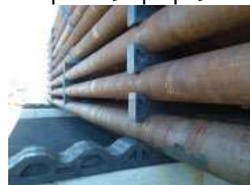
עריסה להובלת צינורות בקוטר גדול ריתום בשתי נקודות לפחות, לאורך הנתמך, באמצעות שרשרת שלוש שמיניות.
