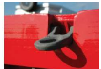
טבעות עיגון שקועות מיועדות לריתום כל סוגי התקני הריתום בעזרת אבזרי קצה שונים. התקנת טבעות עיגון קבועות מתבצעת בעיקר על דופן ההעמסה.
