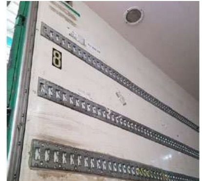
פס עיגון בתוך ארגז סגור למניעת תזוזה של מטען באמצעות מוט טלסקופי.
