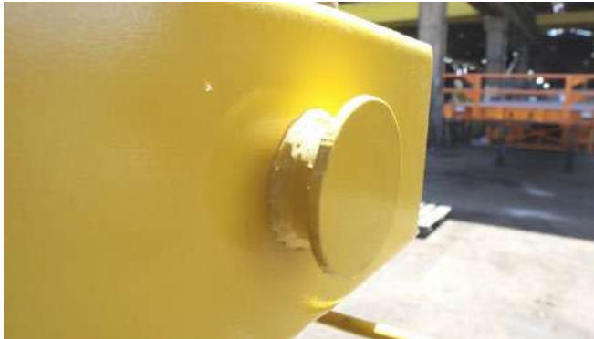
טבעת הטייה לכבל טבעות הטייה לכבל מיועדות לריתום כבלים, בעיקר לריתום בעזרת חיכוך. הטבעות מרותכות לדופן צדית של משטח העמסה ובולטות מרוחב המשטח. כושר ההעמסה של טבעות ההטייה נקבע בהתאם לבדיקת המעבדה ויסומן כנדרש בסעיף 2.5 של התקן הישראלי ת"י 6395 חלק 2.
