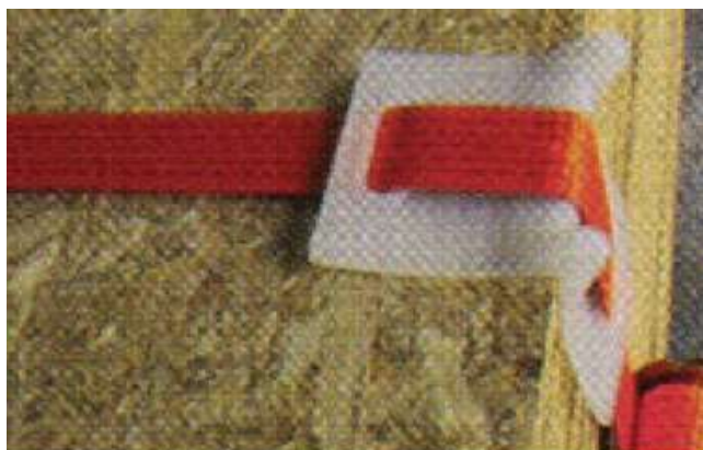
כיסוי פינות של המטען (המלצה) אמצעי כיסוי הפינות יהיו עשויים מעץ, מפלסטיק, ממתכת קלה (סגסוגת) או מחומר מתאים אחר לצורך מניעת שחיקה של התקן הריתום בחיכוך עם פינות חדות של המטען ובכך מניעת סיכון לחיתוך התקן הריתום או לנזק למטען.
