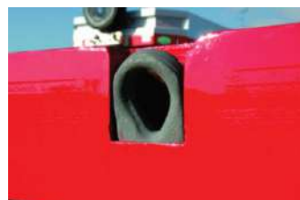
טבעות עיגון שקועות מיועדות לריתום כל סוגי התקני הריתום בעזרת אבזרי קצה שונים. התקנת טבעות עיגון קבועות מתבצעת בעיקר על דופן ההעמסה.
