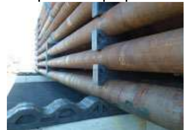
עריסה להובלת צינורות בקוטר גדול ריתום בשתי נקודות לפחות, לאורך הנתמך, באמצעות שרשרת שלוש שמיניות.
