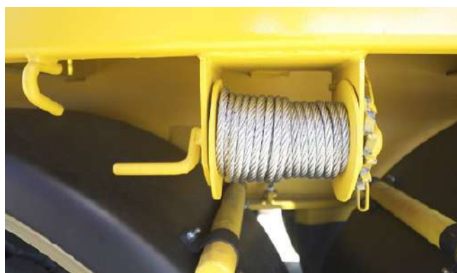
מותחן לכבל פלדה משמש לעיגון מטען לפי סוג המטען ומשקלו
