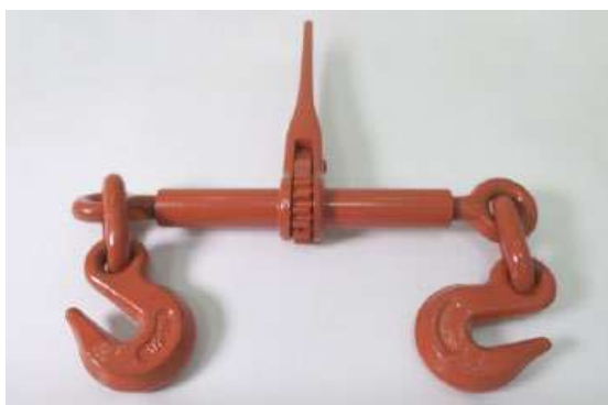
מותחן (ראצ'ר או בומר) משמש להידוק ומתיחת שרשראות בהובלת מטען כבד
